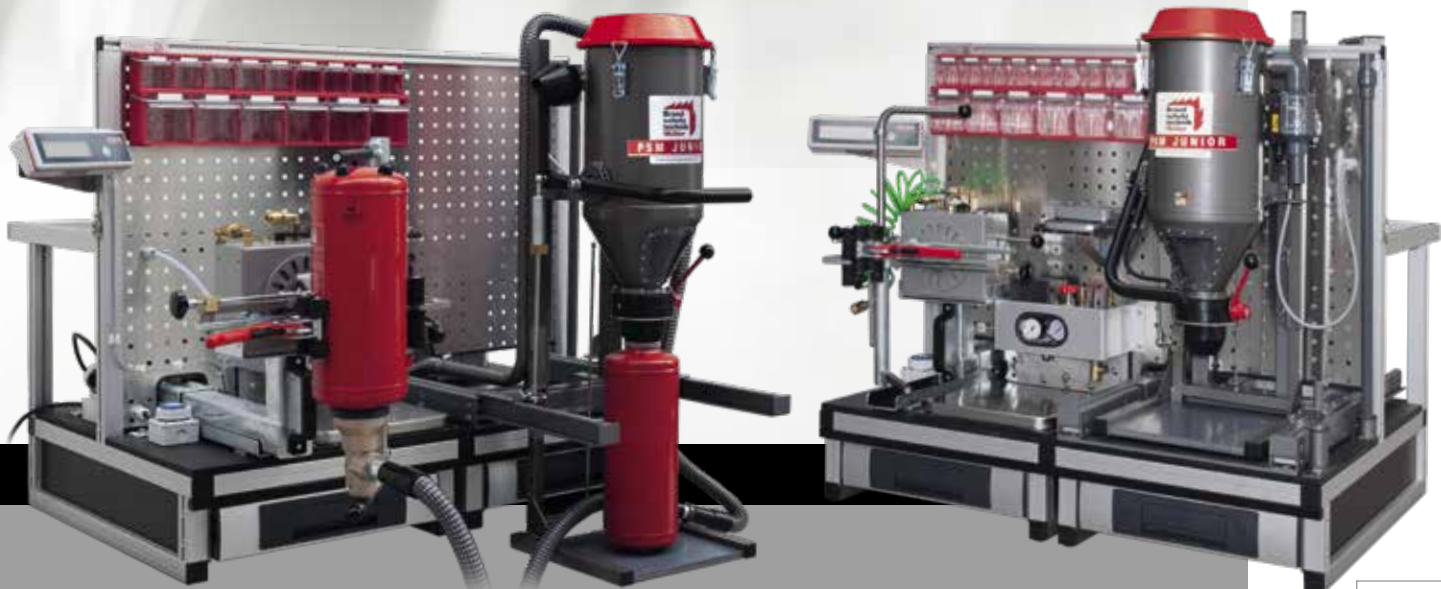
• Löschpulverumfüllung mit dem integrierten Entleersystem FES.
