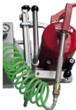
• Absenkbarer Aufstelltisch für das Füllen von Feuerlöschern.
