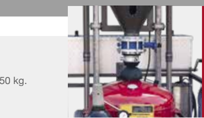
• Umfüllen des Pulvers aus einem Feuerlöscher in einen anderen.
