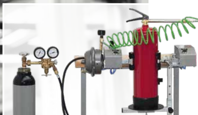
• Pneumatische Spannvorrichtung mit Stickstoff-Füllanlage SVPS .
