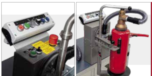
• Zeitsteuerung der Reversierung und elektrische Höhenverstellung.
