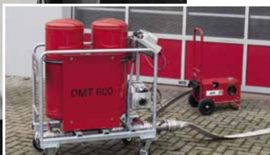
• Durchflussmessgerät DMT 600 im Einsatz.
