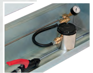
• Prüfung eines Sicherheitsventils mit einem Ventilprüfkopf.
