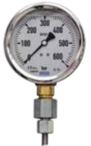
• Am Prüfmanometer (Klasse 1,0) kann der eingestellte Prüfdruck exakt abgelesen werden.
