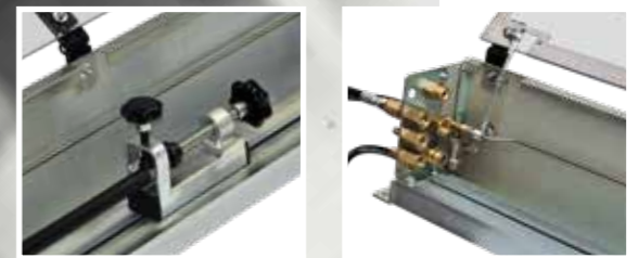
• Prüfung eines Dauerdruck-Feuerlöserschlauches, der mit dem in Längsrichtung beweglichen Düsenverschluß des SPGV verschlossen ist.
