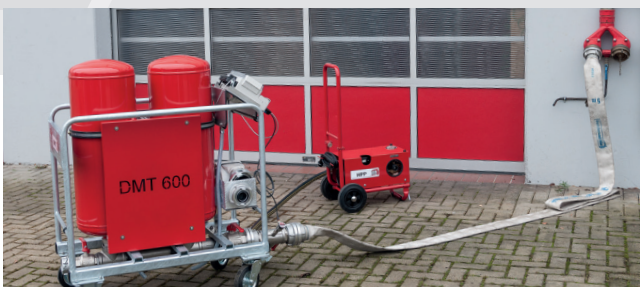
• Durchflussmessgerät DMT 600 im Einsatz.
